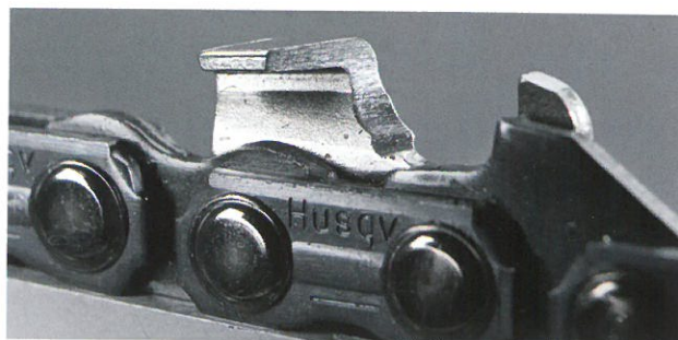
Tahapoolse kalduse nurk. Löikehammas on liiga kõrgeks viilitud ning löikab halvasti. Kasutage teritusmalli ja teritage löikehammas vastavalt soovitudele uuesti.
