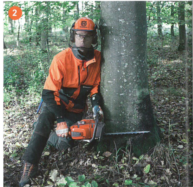
2. Sihtige selle maastikupunkti suunas, kuhu soovite puu langetada. Sihtpunkt peab kattuma sae langetussuuna märgetega (joontega).
