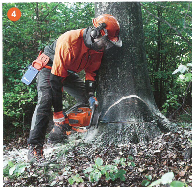
4. Tehke alumine löige nii, et see kohtuks täpselt ülemise löikega. Veenduge, et alumine löige poleks liiga sügav. Kui ülemine ja alumine löige ei ole kohakuti, ei suuda te langevat puud piisavalt kontrollida. Samuti on oluline, et saag oleks alumise löike tegemise ajal horisontaalselt.
