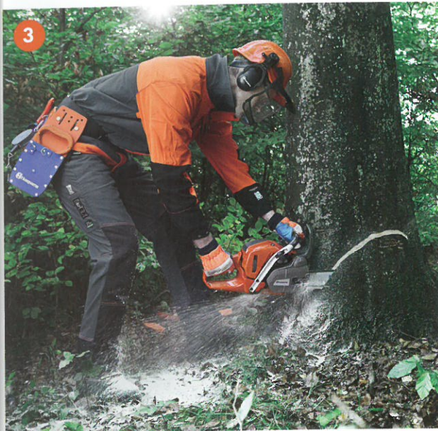
3. Seadke juhtplaat nurga alla ja hakake täiskiirusel saagima. Kontrollige aeg-ajalt, et olete samas tööasendis nagu algul.
