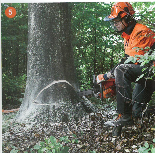
5. Kui langetate jämedamaid puid, tuleb sõltuvalt juhtplaadi pikkusest mõnikord ülemist löiget vastassuunast jätkata.
