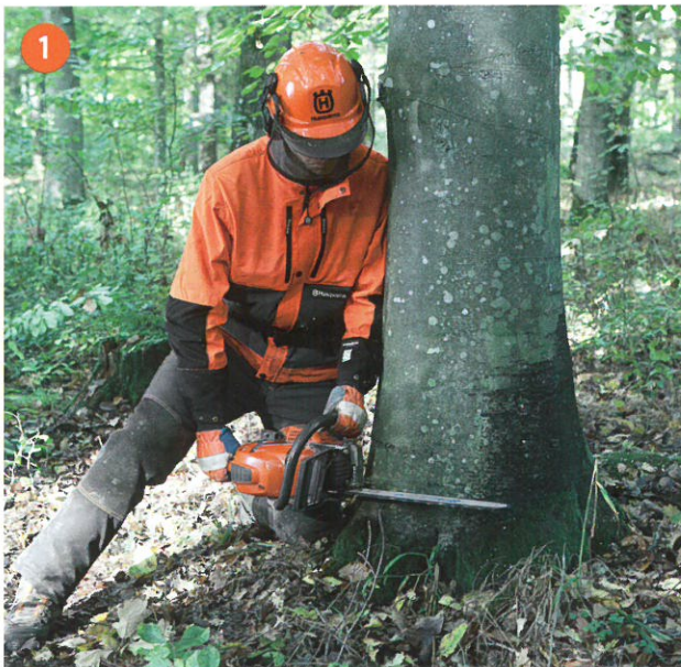
1. Hoidke juhtplaat soovitud kändukõrgusel horisontaalselt.
