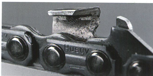
Siin näete, milline on nürri löikehammas. On viimane aeg löikehamba teritamiseks. Pange tähele hamba valget serva.
